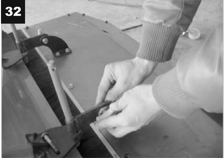
Fix the dust collector to machine by bolts and knobs / Закріпіть пилозбірник на машині за допомогою болтів і ручки на адаптері / Připevněte zásobník pomocí šroubů a matic na stroj / Připevnite zásobník pomocou skrutiek a matic na stroj / Zamocować podajnik pomocą śrub do maszyny
